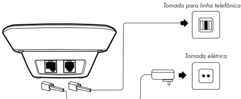
Para a base, utilize o adaptador de tensão energia marcado com as informações de saída de 7,5 V DC, 300 mA.
